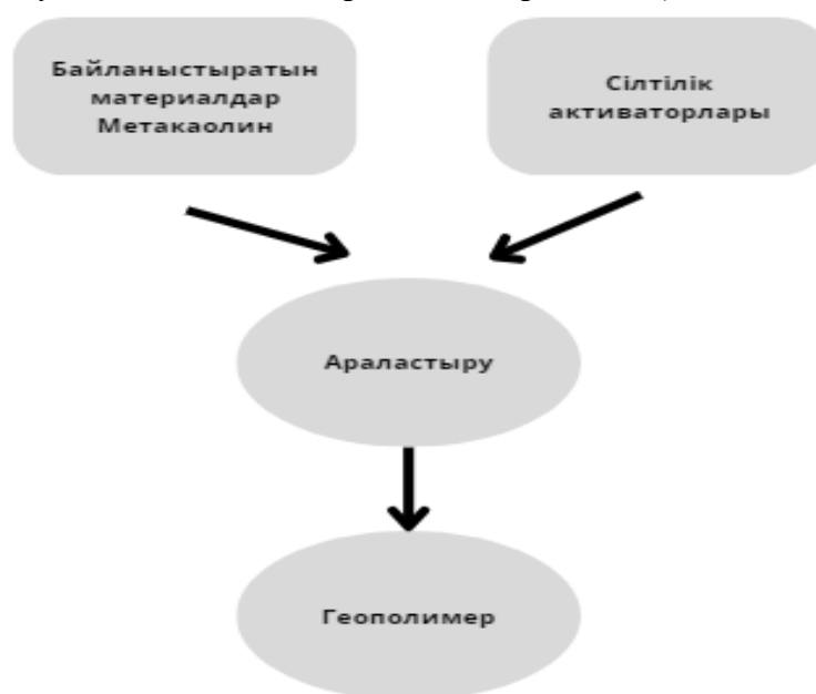
Сурет-3 Геополимер түзілуінің схемалық диаграммасы
