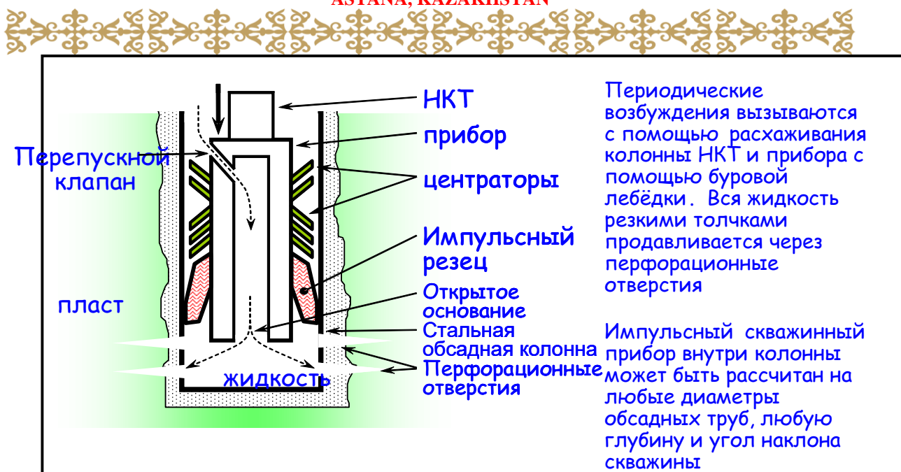
Рисунок 2- Использование на забое независимого поршня в качестве инструмента, приводимого механико-гидравлическими средствами
