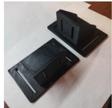
1 – сурет - Дисплей контроллеріне арналған корпус және NEMA 17 қадамдық қозғалтқышына арналған күшейтілген реттелетін көлденең қондырғы
